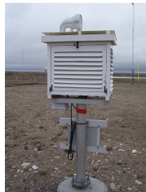
Stevenson screen. Proteção para instrumentos meteorológicos.
