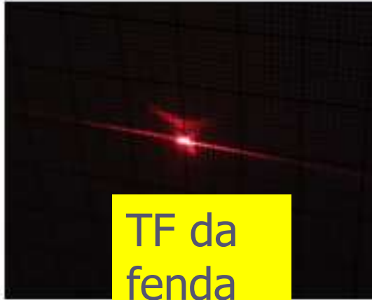
Figura 1: Imagens correspondentes ao experimento com o uso da fenda (gilettes). Na ordem da esquerda para direita: 1-Objeto fenda ; 2-Imagem recomposta do objeto ; 3- Figura de difração da fenda; 4-Transformada do objeto
