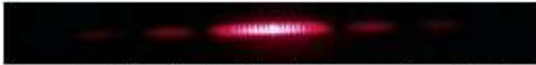
Figura 3 – Difração do feixe de laser em fenda dupla.
