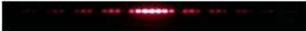
Figura 4 – Difração do feixe de laser em fenda dupla, com mesma abertura e separação menor.
