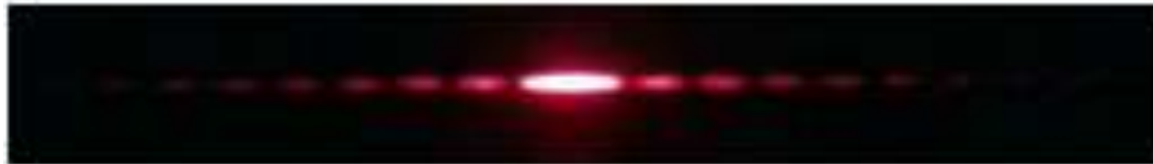
Figura 2 – Difração do feixe de laser em uma fenda simples de abertura maior.
