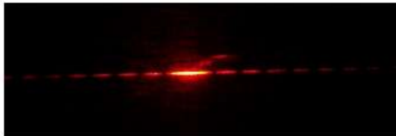
Figura 4: Foto da transformada de Fourier da fenda simples gerada após o feixe do laser atravessar o arranjo mostrado na figura 2 . O anteparo onde se observou a figura de difração está posicionado na distância focal à esquerda da lente L1, ou seja, no plano de Fourier do sistema.
