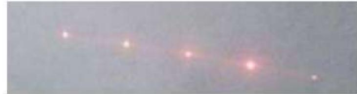
*figura III – figura de difração da grade*
