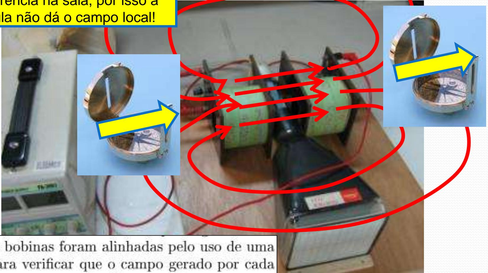
restre. As bobinas foram alinhadas pelo uso de uma bússola para verificar que o campo gerado por cada uma estava na mesma direção e sentido.
