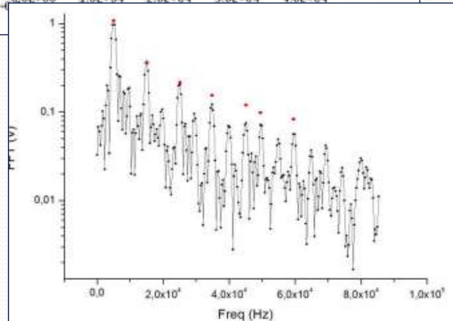
(fig 1) FFT da onda quadrada
