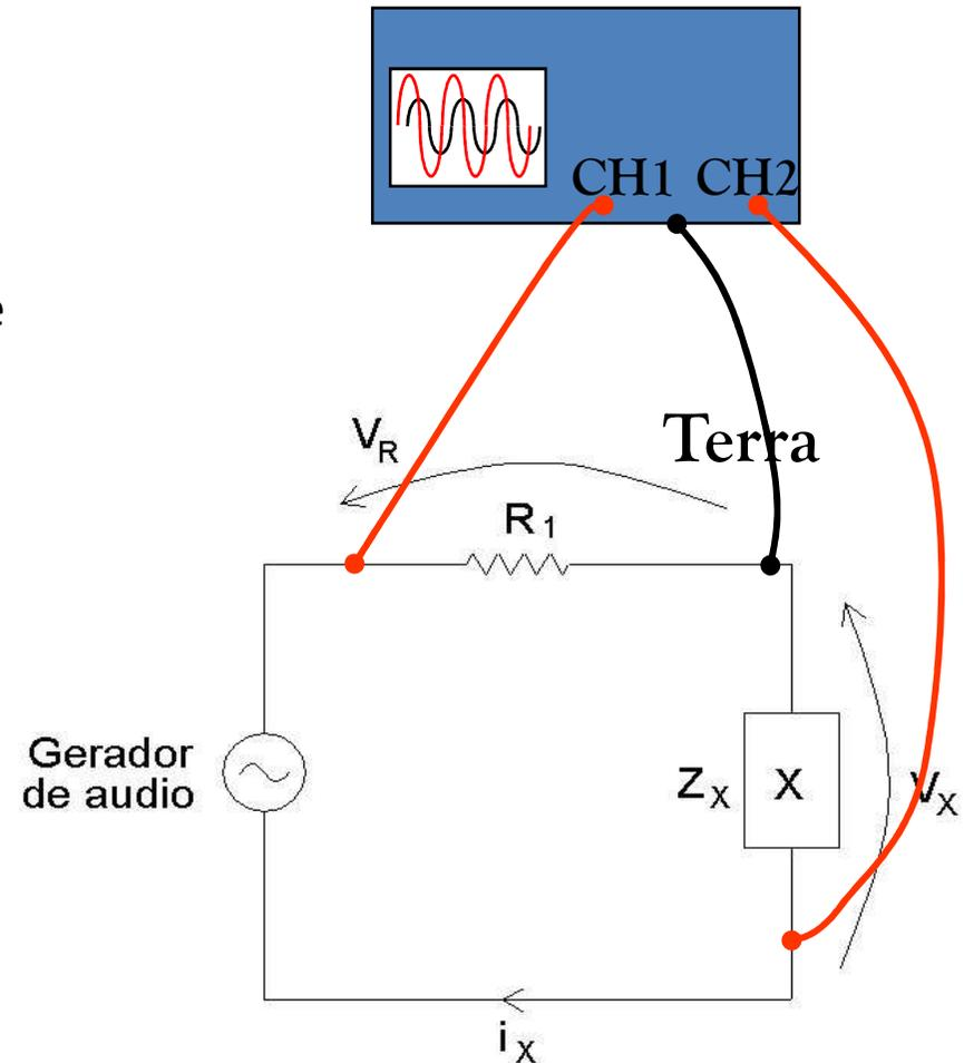
Ligação do osciloscópio com centro em terra. Para correta medida de fase é necessário inverter uma das medidas (ou subtrair  $\pi$ , da diferença de fase medida).
