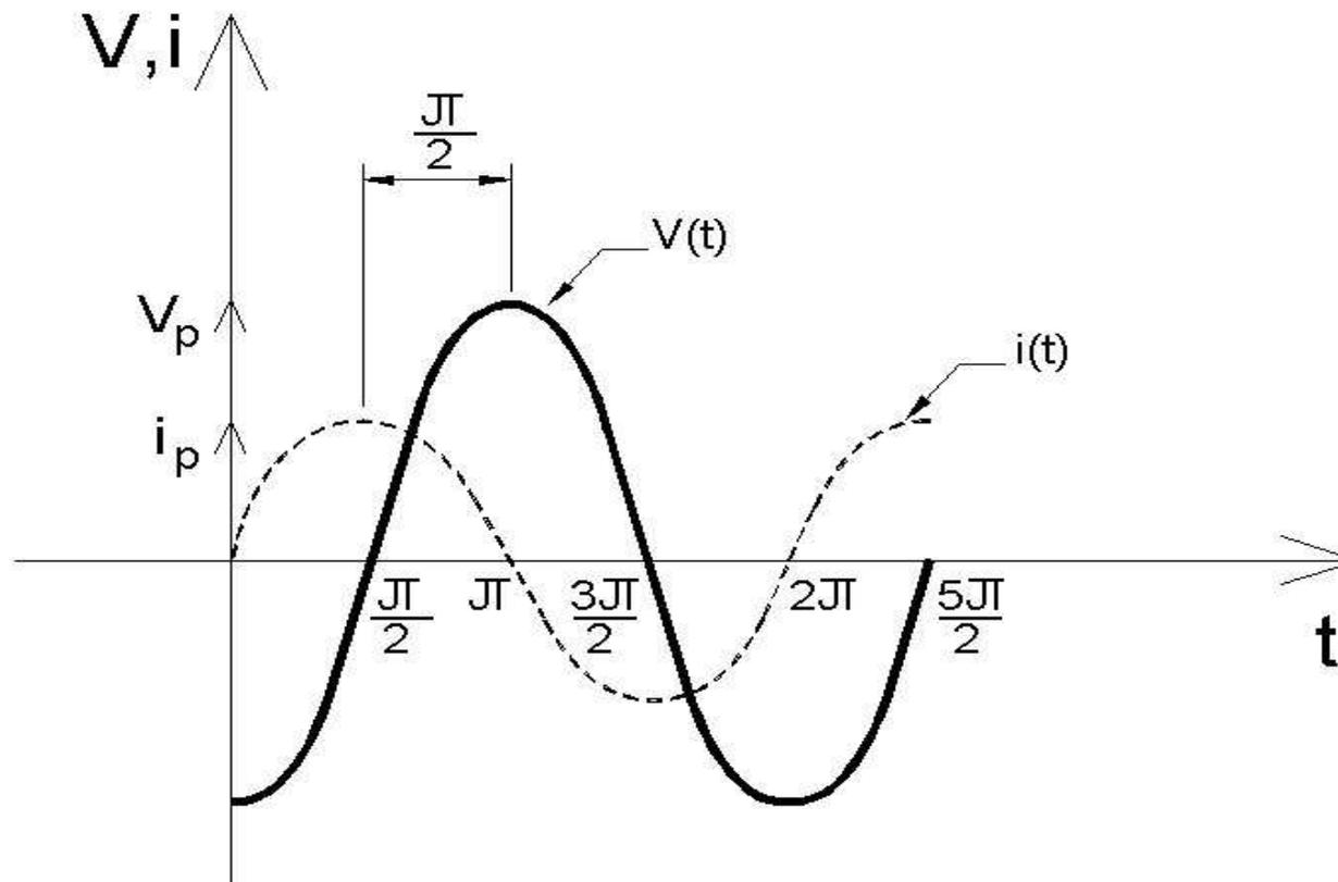
a corrente está adiantada de  $\pi/2$  em relação à tensão aplicada ao capacitor (**Atenção: a defasagem de  $\pi/2$  é entre a corrente e a tensão diretamente sobre o capacitor e não quaisquer outras.**)
