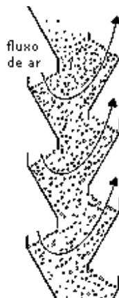
Figura 7. 52 - Adsorvedor de leito móvel. Fonte: SCHIRMER (2000)
