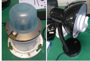
Fig. 1 – A esquerda temos uma imagem da câmera coberta por um recipiente que foi utilizado apenas para tornar a luz difusa. Na imagem da direita temos a luminária utilizada para saturar o sensor.
