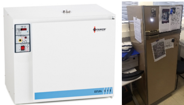
Fig. 7 – Estufa Fanem modelo 515 (esquerda) e geladeira (direita) utilizadas para variar a temperatura da câmera para o estudo do ruído de fundo.
