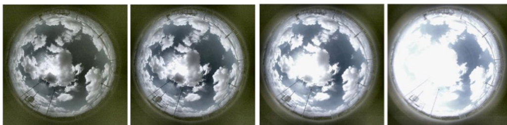
Fig. 9 – Imagens geradas pela câmera com tempos de exposição de 100ms, 250ms, 700ms e 1500ms. As imagens foram obtidas no dia 14-jan-2017 às 15h45m
