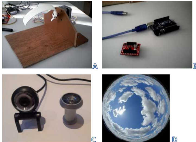
Figura 3.1.2: A : protótipo de madeira com o motor de passo e o anteparo. B : placa Arduino UNO e controlador do motor BIG EASY DRIVER. C : webcam comum e lente tipo olho mágico. D : fotografia de teste.
