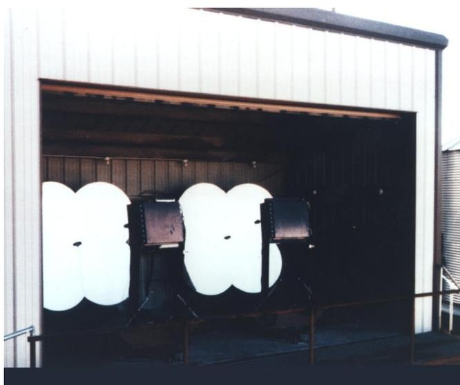
Figura 2.5: Telescópios de fluorescência utilizados no HiRes. Cada um é composto por quatro espelhos e um conjunto de fotomultiplicadoras [13].
